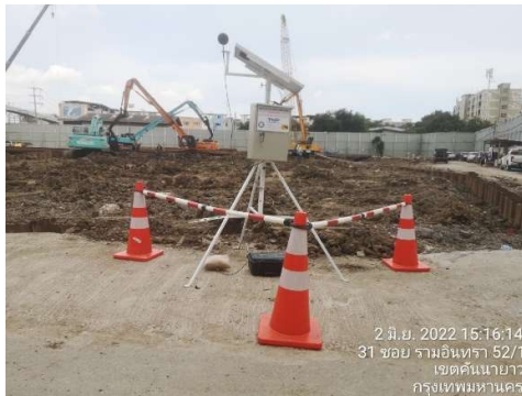
รูปที่ 16 การตรวจวัดระดับเสี่ยงและความสั่นสะเทือนบริเวณพื้นที่โครงการ
